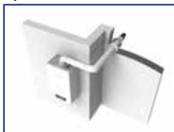
Рисунок 1.3.2 Максимальная эквивалентная длина: 6 м
