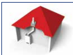
Рисунок 1.3.4 Максимальная эквивалентная длина: 20 м
